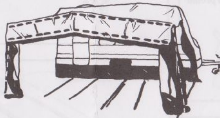
D) Postavte vnější středovou tyčku do otvoru ve stanu. Do vnější středové tyčky vložte vnější horní tyčku směrem k boku, postavte boční tyčku do stanu a spojte s boční tyčkou. To samé udělejte na opačné straně.
